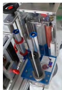
Sistema eletropneumático de rotação para rotulagem posicionada
