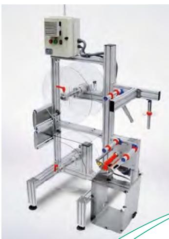
Desbobinador com duplo suporte de bobinas para troca semiautomática
